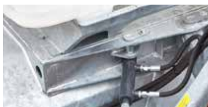
Dispositif d'orientation hydraulique incl. pupitre de commande
