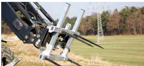
Version avec rehausse et 4 dents de balle ronde (2 dents de série)
