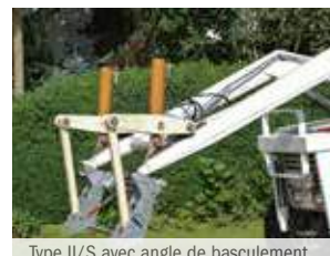
Type II/S avec angle de basculement jusqu'à 180°
