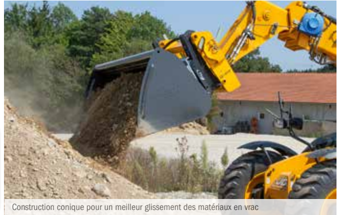
Construction conique pour un meilleur glissement des matériaux en vrac
