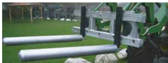
Tubes à emboîter pour transport de balles rondes sécurisés par des boulons
