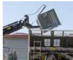
Angle de basculement jusqu'à env. 71°
