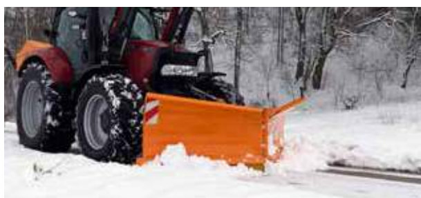
Galvanisée et peinte pour une meilleure protection anti-corrosion
