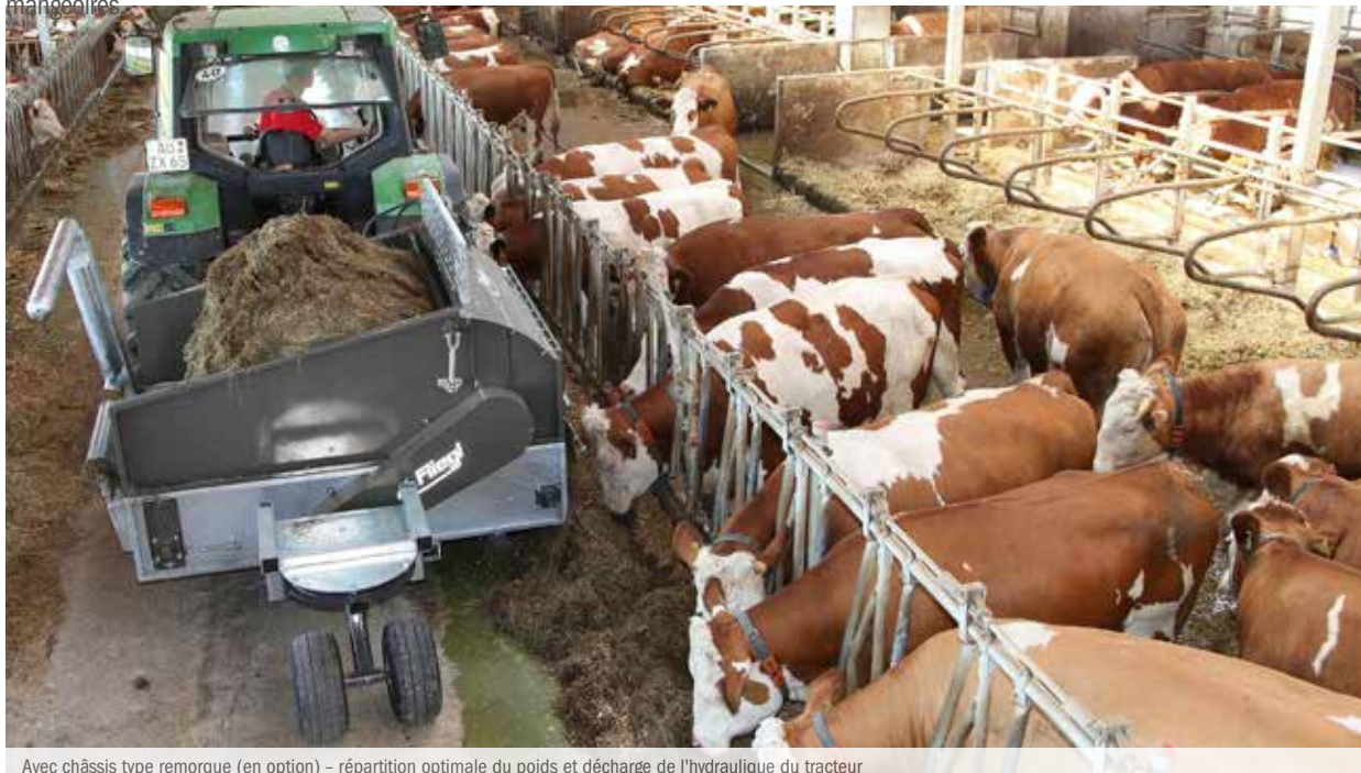
Avec châssis type remorque (en option) – répartition optimale du poids et décharge de l'hydraulique du tracteur
