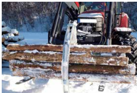
Bras de préhension hydraulique fixé à la fourche à palette multifonction « Freisicht »
