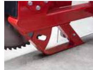
L'arceau de sécurité empêche la lame de scie la plus basse d'entrer en contact avec le sol.
