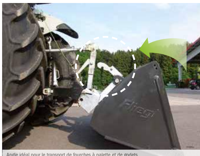
Angle idéal pour le transport de fourches à palette et de godets
