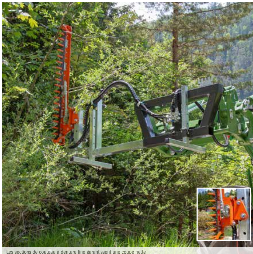
Les sections de couteau à denture fine garantissent une coupe nette
