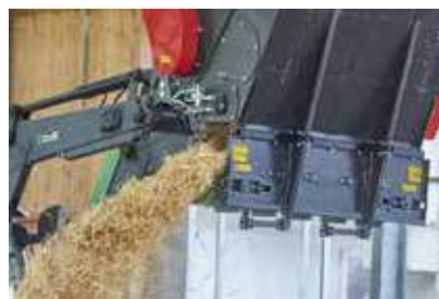
3 rouleaux de dosage avec couteaux
