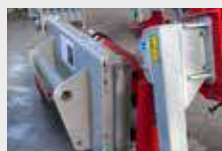
Exemple : lamier à scies avec attelage à boulonner pour Manitou
