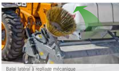
Balai latéral à repliage mécanique
