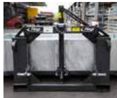
Attelage Euro, trois points et chariot élévateur combiné
