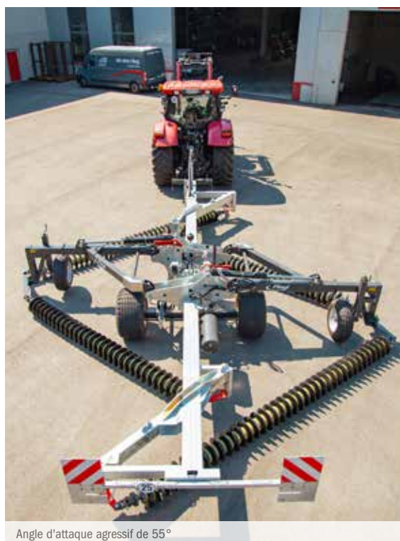
Angle d'attaque agressif de 55°
