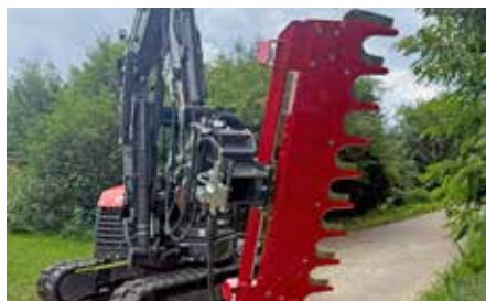
Bras à extension latérale sur 1200 mm. Barre de coupe en acier HB 500 très résistant à l'usure
