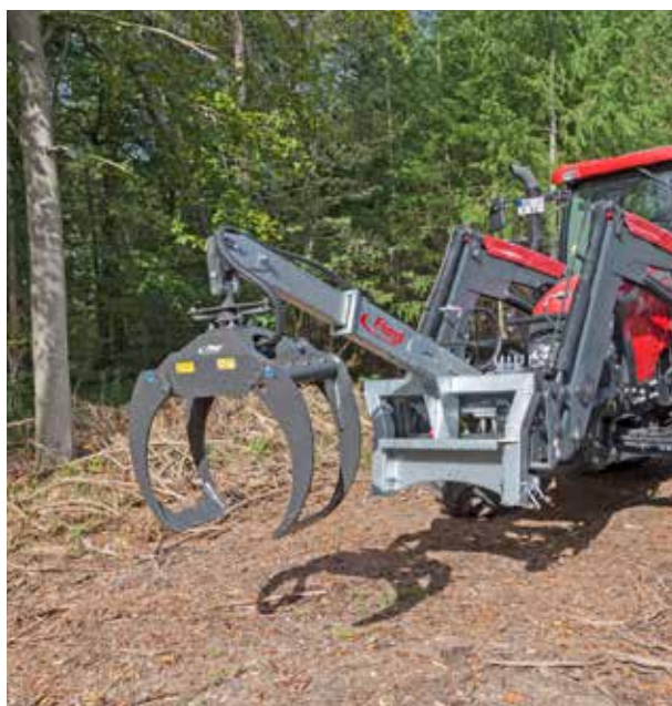
Grappin « LongNeck Combi » hydraulique avec articulation mécanique
