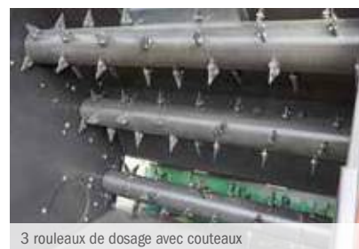
3 rouleaux de dosage avec couteaux
