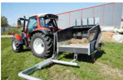
Adaptation hydraulique du bras de chargement
