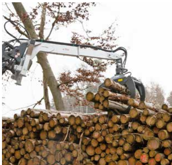
Grappin « LongNeck Combi-Plus » hydraulique avec rotateur
