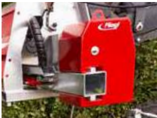
Le contrepoids latéral contribue à réduire la charge unilatérale sur le bras oscillant du véhicule porteur
