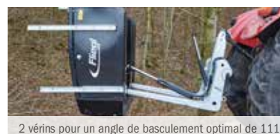
2 vérins pour un angle de basculement optimal de 111°
