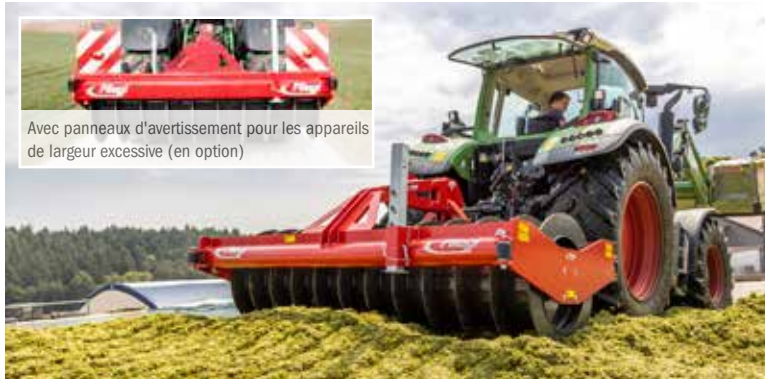
Rouleau de tassement à déport bilatéral
