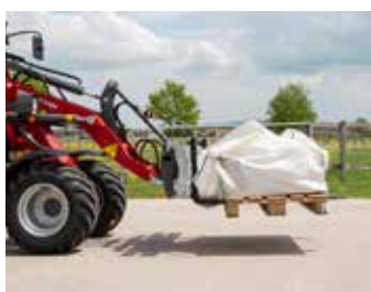
Arceau de sécurité (en option) pour éviter le glissement, par ex. de tas de bois, de balles, de profils en acier, etc. – pour rééquipement facile et rapide
