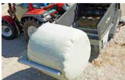
Bras de chargement réglable hydrauliquement
