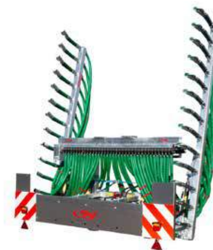
Protection de transport avec éclairage et panneaux d'avertissement (de série)
