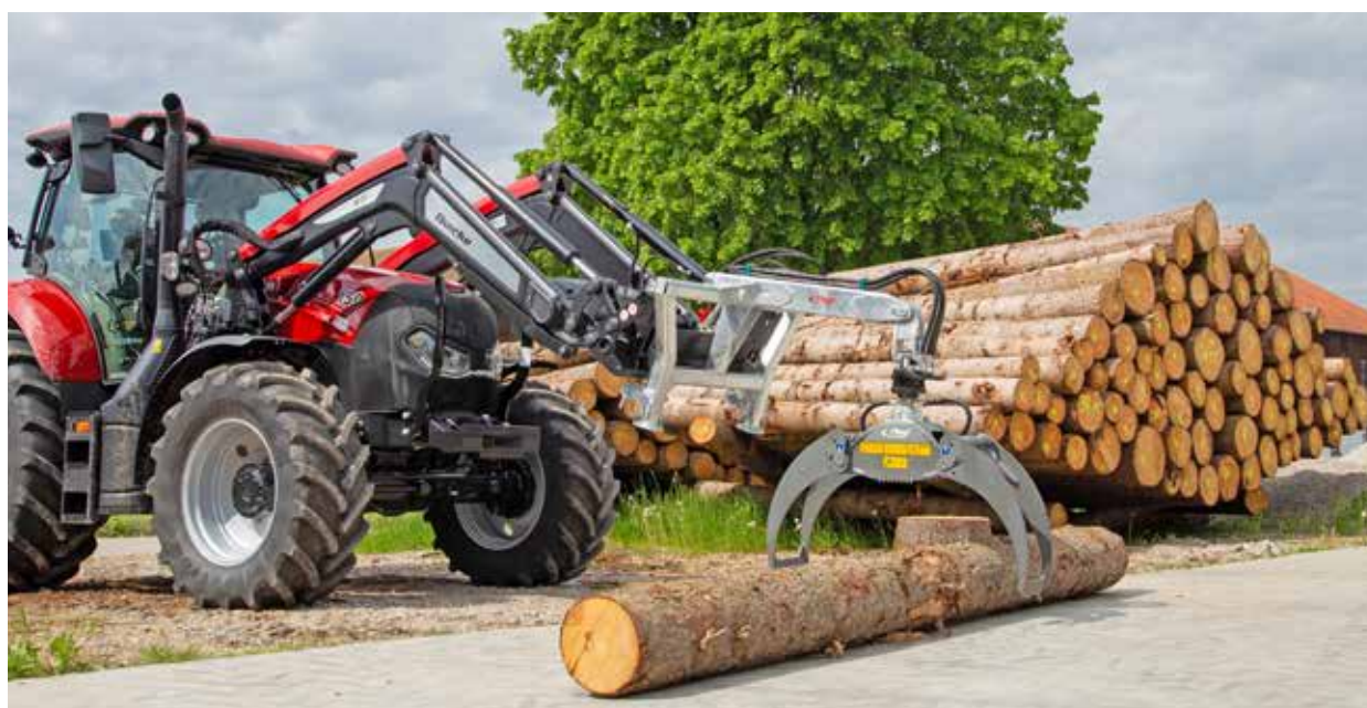
Grappin avec rallonge de crochet de levage, rotateur, attelage Euro et trois points
