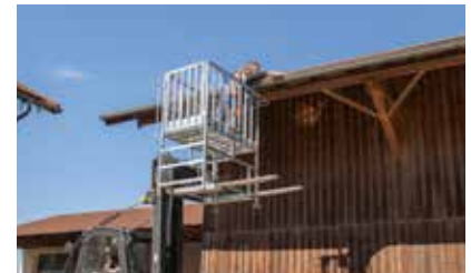
Attelage au chariot élévateur avec sécurité de la chaîne
