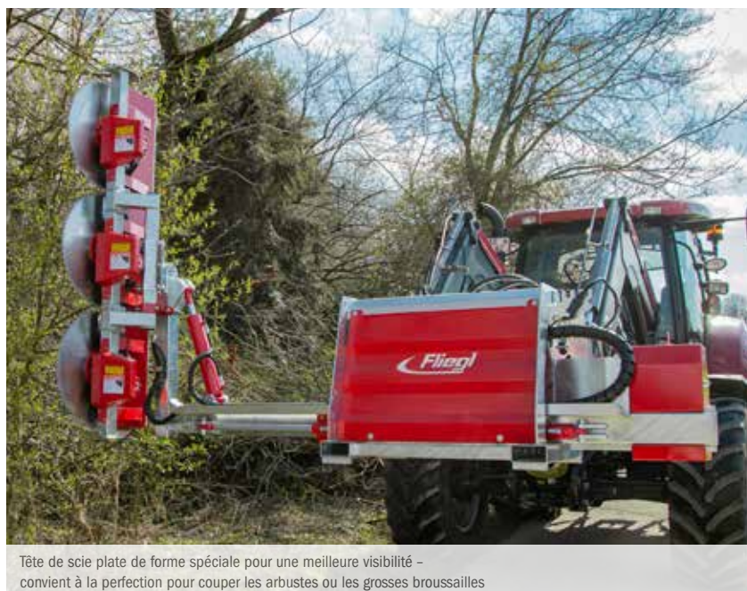
Entraînement des lames de scie via des moteurs hydrauliques
