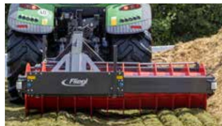
Rouleau de tassement à déport bilatéral
