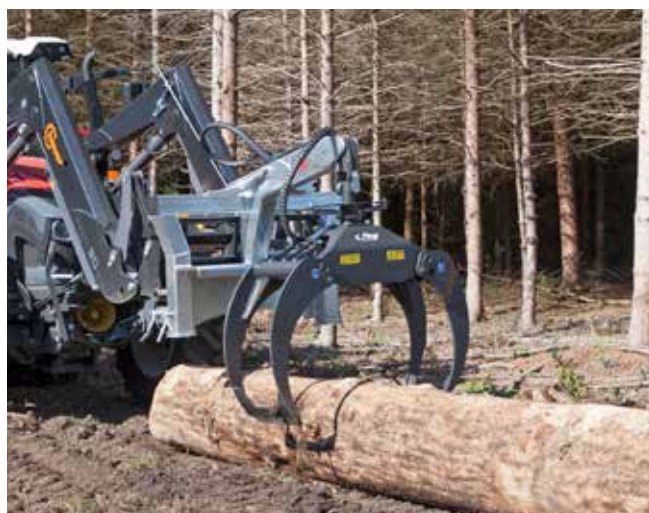
Grappin « RZ 185 Combi » hydraulique avec articulation mécanique
