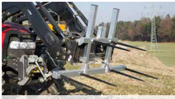
Version avec rehausse et 6 dents de balle ronde (4 dents de série)
