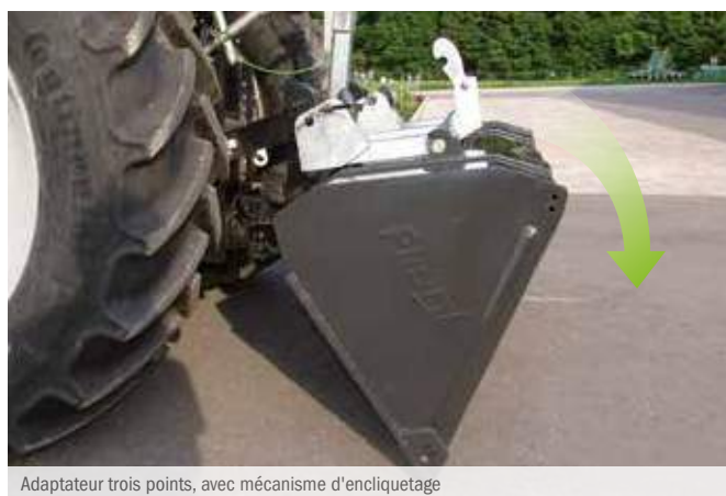
Adaptateur trois points, avec mécanisme d'encliquetage
