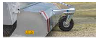
Roues porteuses pour lourdes charges Ø 306 mm – roues en caoutchouc plein ultra-élastique, largeur 105 mm, montées sur roulement à billes, bande de roulement résistante à l'abrasion, version avec couronne de rotation lourde
