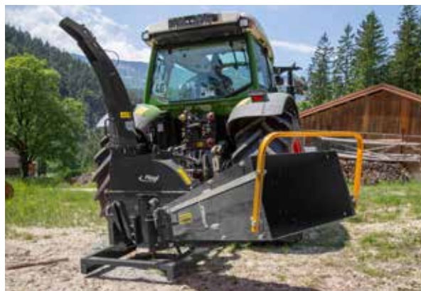
Angle d'ouverture du bec d'éjection réglable
