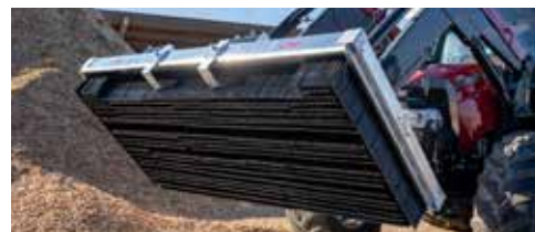
Rangées de balais remplaçables et patins de stationnement pour un stockage sans dommages
