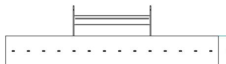
Illustration : racloir en caoutchouc avec fils d'acier vulcanisés (en option)
