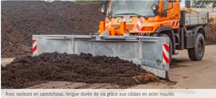
Avec racleurs en caoutchouc, longue durée de vie grâce aux câbles en acier moulés
