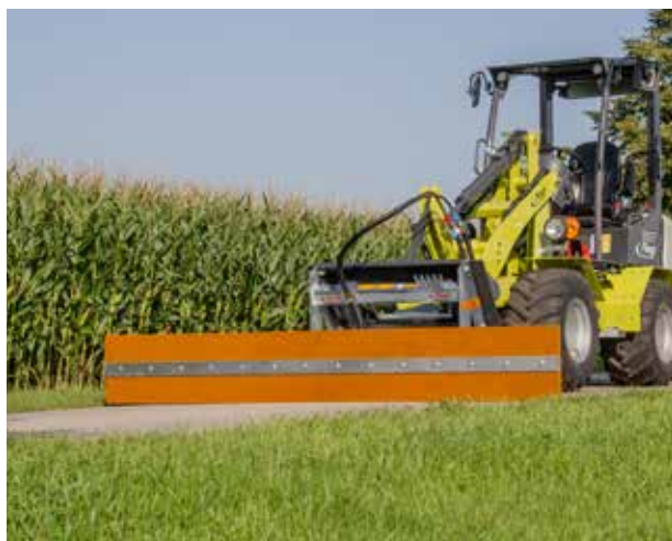
Illustration : racloir en caoutchouc avec fils d'acier vulcanisés (en option)
