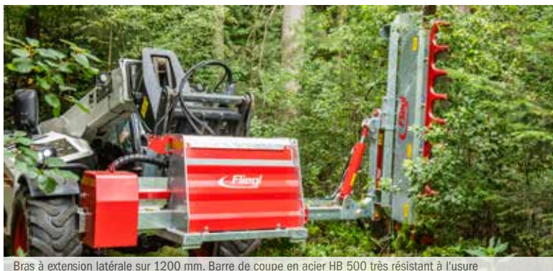
Bras à extension latérale sur 1200 mm. Barre de coupe en acier HB 500 très résistant à l'usure
