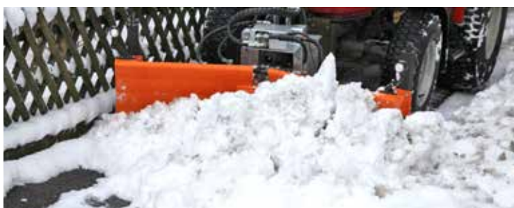
2 panneaux à orientation hydraulique avec commande séparée
