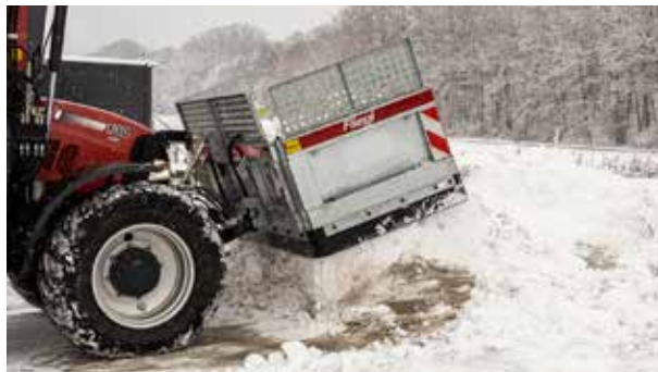
Largeur de déblayage réglable en continu par les 2 panneaux latéraux, grillage de rehausse (en option)
